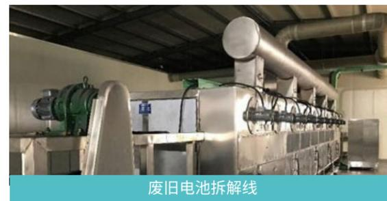
废旧电池拆解线
